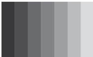
Рис. 5.24. Семь полос постоянной интенсивности, заполненных полутоновыми значениями 31 + 32k , где k = 1, 7 . Вследствие эффекта полос Маха люди могут увидеть на этом изображении ребристые или вогнутые пластины.
