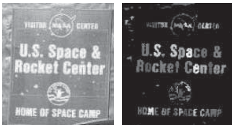
Рис. 6.10. Белые пикселы, выделенные в результате сегментации левого цветного изображения. Отдельные связные компоненты белых пикселей маркированы с помощью алгоритма маркировки из гл. 3. (С любезного разрешения David Moore.) См. цветную вклейку.
