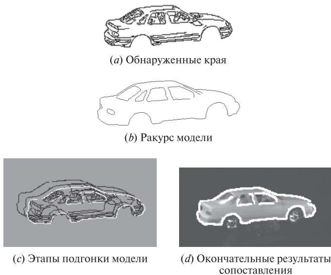
Рис. 14.23. Сопоставление карт перепадов с использованием масштабного множителя s для масштабирования 1:2. (a) Наблюдаемая карта перепадов. (b) Модельная карта перепадов. (c) Сходимость алгоритма совмещения. (d) Сглаженная карта перепадов, показанная с наложением на исходное изображение. (С любезного разрешения Jin-Long Chen.)
