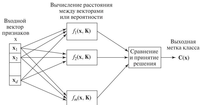
Рис. 4.2. Схема системы классификации: классифицирующие функции f(x, K) выполняют вычислительные операции над входным вектором признаков x с использованием некоторых сведений K , полученных на этапе обучения. Результаты вычислений передаются на окончательный этап обработки, на котором определяется класс объекта.
