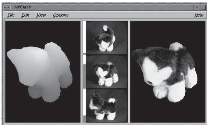
Рис. 15.17. (Слева) дальнометрические данные модели игрушечной собаки. (В центре) три реальных цветных изображения, на которых вид игрушечной собаки наиболее похож на вид, соответствующий указанной пользователем точке наблюдения. (Справа) изображение с результатами рендеринга с использованием взвешенной комбинации пикселей выбранных видов. (С любезного разрешения Kari Pulli.) См. цветную вставку.
