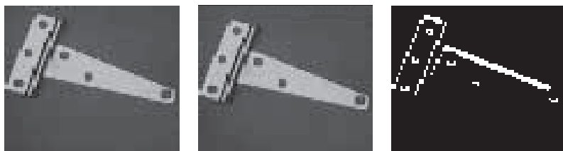
Рис. 1.10. Изображения движущейся детали ( слева и в центре ) и разностное изображение, на котором заметна граница детали.
