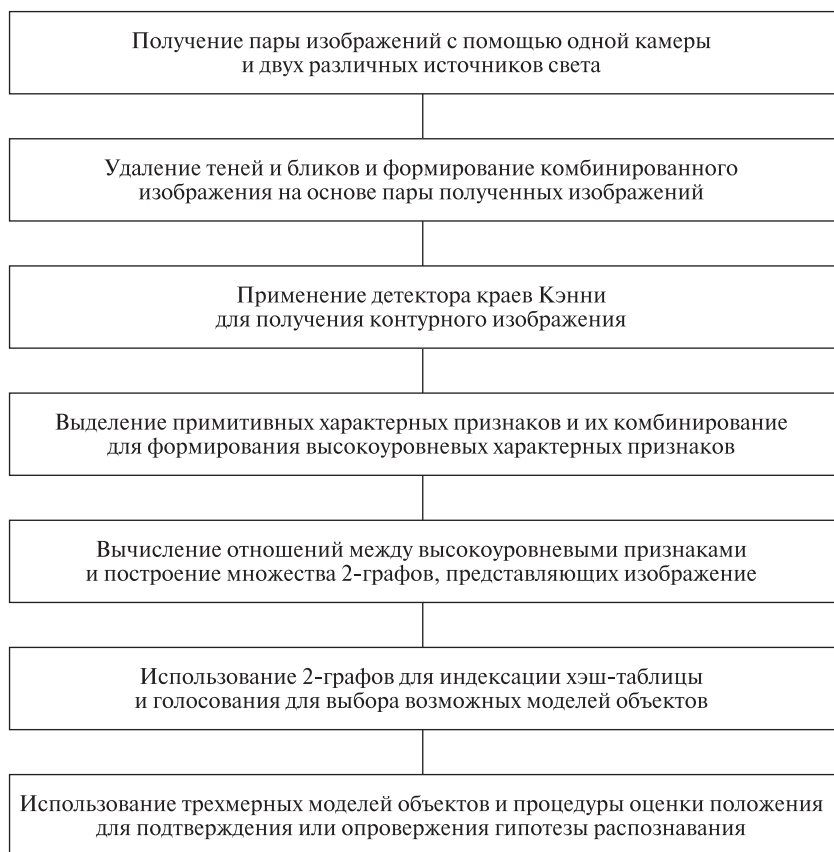
Рис. 14.35. Схема работы системы распознавания объектов RIO.
