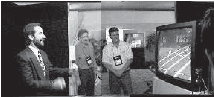
Рис. 9.3. Для управления персонажем компьютерной игры игрок, находящийся слева, руками имитирует движения бегуна с препятствиями. Справа расположен игровой экран. В правом нижнем углу видна камера для наблюдения за движением игрока, которая используется для управления скоростью и прыжками игрового персонажа. (Воспроизведено по IEEE Computer Graphics , Vol.18, No.3, May–June 1998 с разрешения IEEE.)
